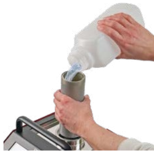
Baño de calibración Llenado directo o inserto tipo recipiente
